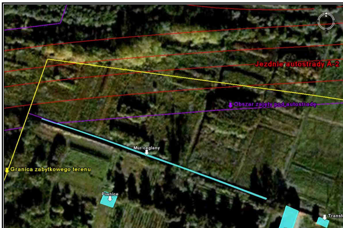
Rys. 6.35 Przebieg planowanej A-2 względem zabytkowego muru
