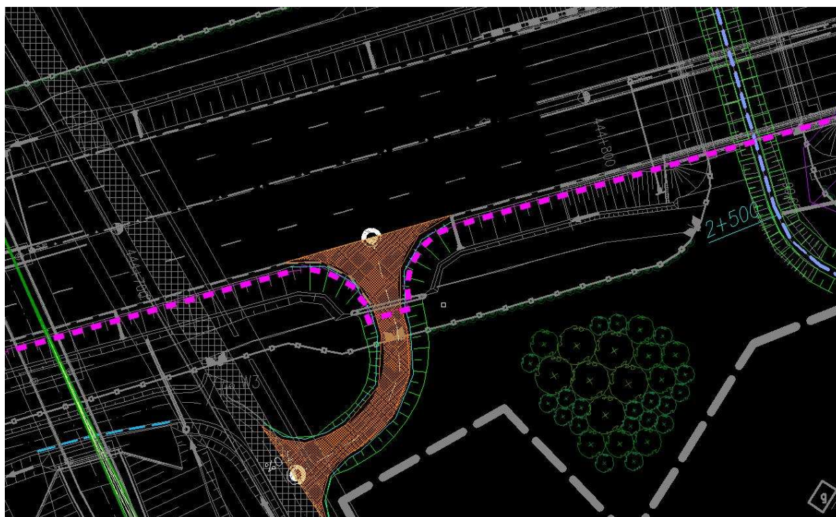
Ryc. 13 Brama w ekranie (strona południowa km 444+750).
