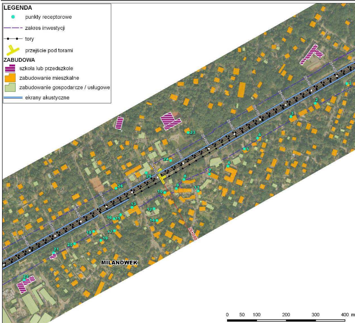
Rys. 5.5 Lokalizacja receptorów poziom dźwięku
