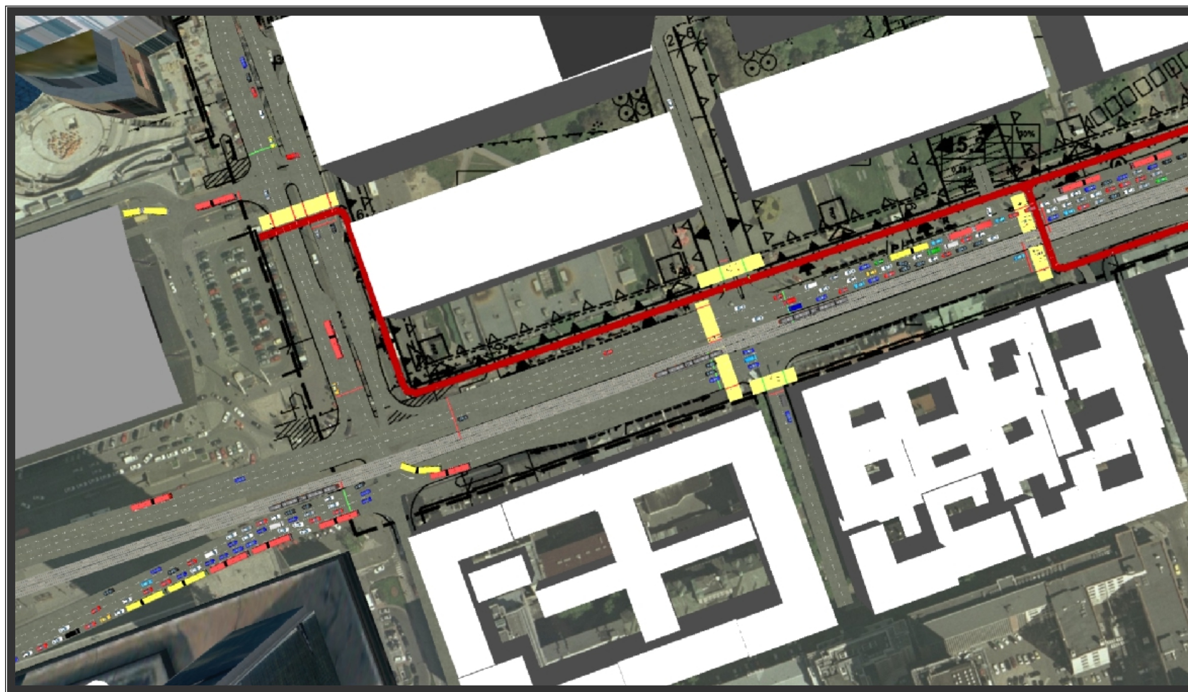
Rys. 30 Obraz ruchu w rejonie skrzyżowania Al. Jerozolimskich i ul. E. Plater w godzinie szczytu porannego - wariant 0
