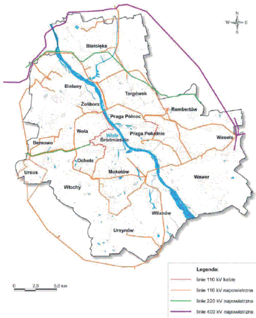
Rysunek 19. Rozkład linii elektroenergetycznych w Warszawie
