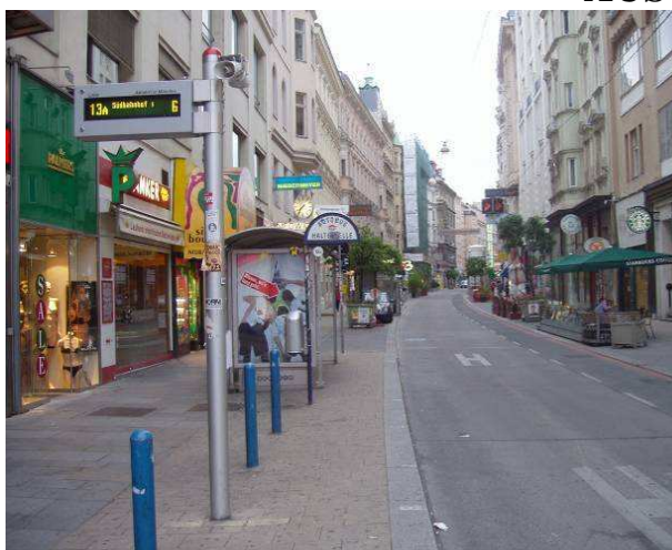
Fot. 63. Wiedeń, pas autobusowy wyznaczony na ulicy jednokierunkowej z kontrapasem rowerowym.
