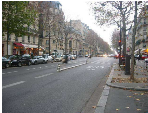
Fot. 50. Paryż, pas autobusowy – widoczne oznakowanie pasa przed skrzyżowaniem i na skrzyżowaniu – oznaczenie powierzchni potencjalnych kolizji autobusów z ruchem samochodowym
