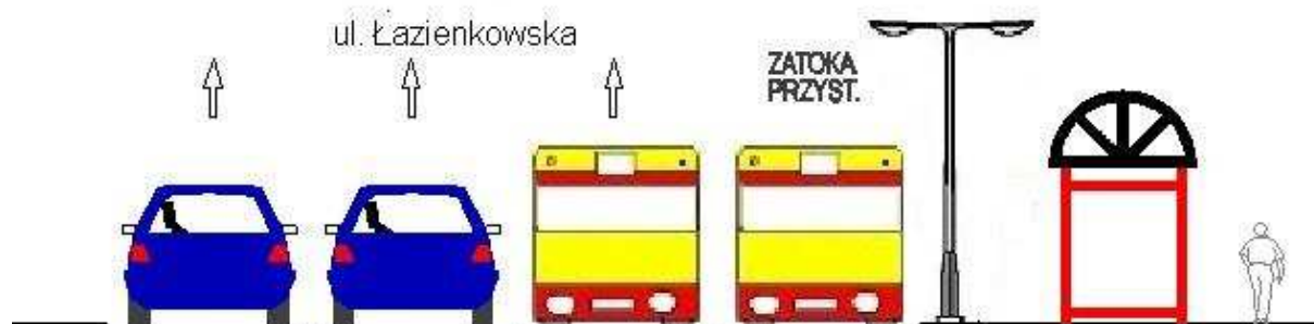
Rys. 32. Położenie pasa autobusowego na wysokości przystanków z zatoką: CHEŁMSKA SIELCE, BARTYCKA, SZWOLEŻERÓW, LEGIA STADION
