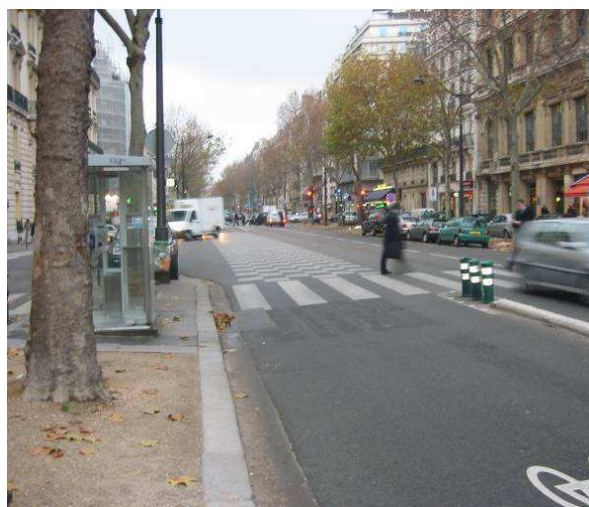
Fot. 48. Paryż, pas autobusowy wydzielony z wykorzystaniem separatora. Widoczne oznakowanie początku wydzielenia pasa.
