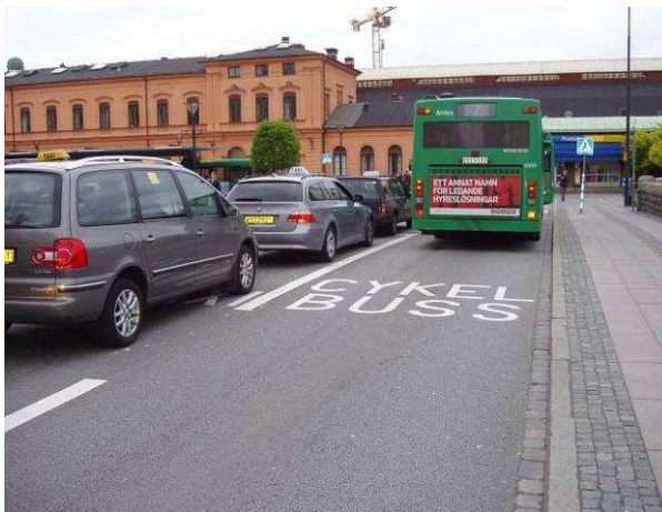
Fot. 62. Malmö, pas autobusowy wyznaczony na ulicy dojazdowej do dworca kolejowego – wspólne wykorzystanie z rowerzystami
