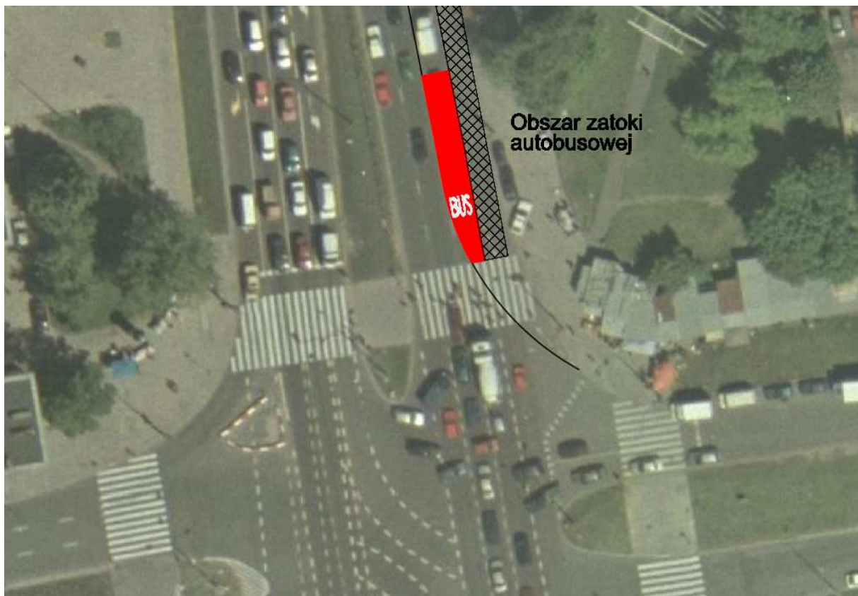
Rys. 31. Skrzyżowanie ul. Czerniakowskiej z Gagarina. Schemat poprowadzenia linii krawędziowej dla pojazdów skręcających w prawo oraz przykład oznaczenia innym kolorem pasa autobusowego na wylocie skrzyżowania.
