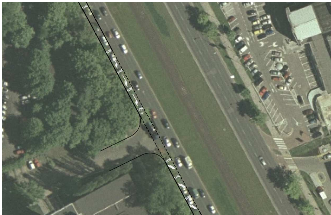
Rys. 36. Schemat organizacji zjazdu i wyjazdu do obiektów usytuowanych po zachodniej stronie ul. Towarowej.
