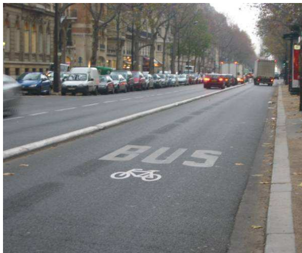
Fot. 47. Paryż, pas autobusowy z dopuszczonym ruchem rowerowym. Widoczne wydzielenie z wykorzystaniem separatora
