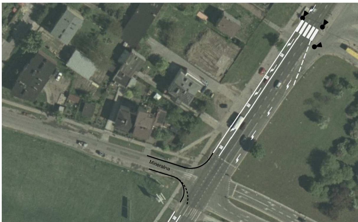
Rys. 39. Al. Krakowska, schemat usytuowania pasa i organizacji ruchu na odcinku pomiędzy wyjazdem z pętli autobusowej Okęcie a skrzyżowaniem z ul. Mineralną.
