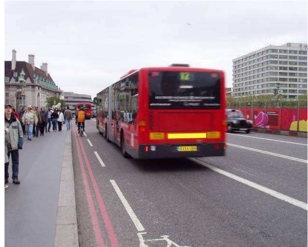
Fot. 52. Londyn, pas autobusowy wyznaczony za pomocą oznakowania poziomego z dopuszczonym przy prawej krawędzi ruchem rowerowym
