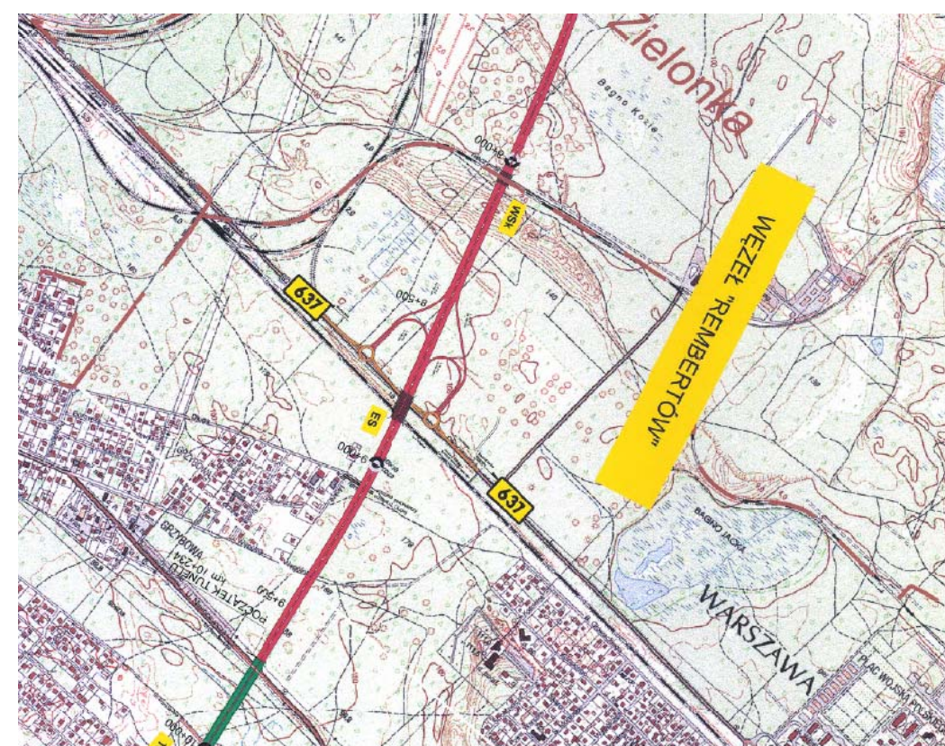
Rysunek 5 - 27 Mapa orientacyjna przedstawiająca planowane przecięcie linii kolejowych nr 2 i 448 (projekt nr 5) oraz drogi ekspresowej S17
