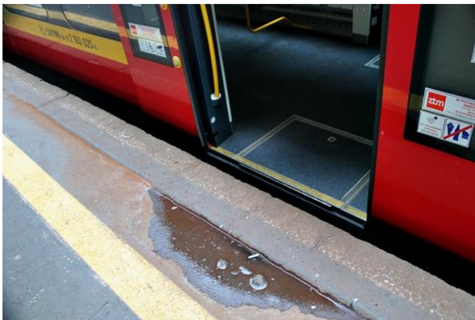
Zdjęcie 30 PKP Ochota. Pociąg SKM Pesa ELF ma podłogę na poziomie niższym niż peron
