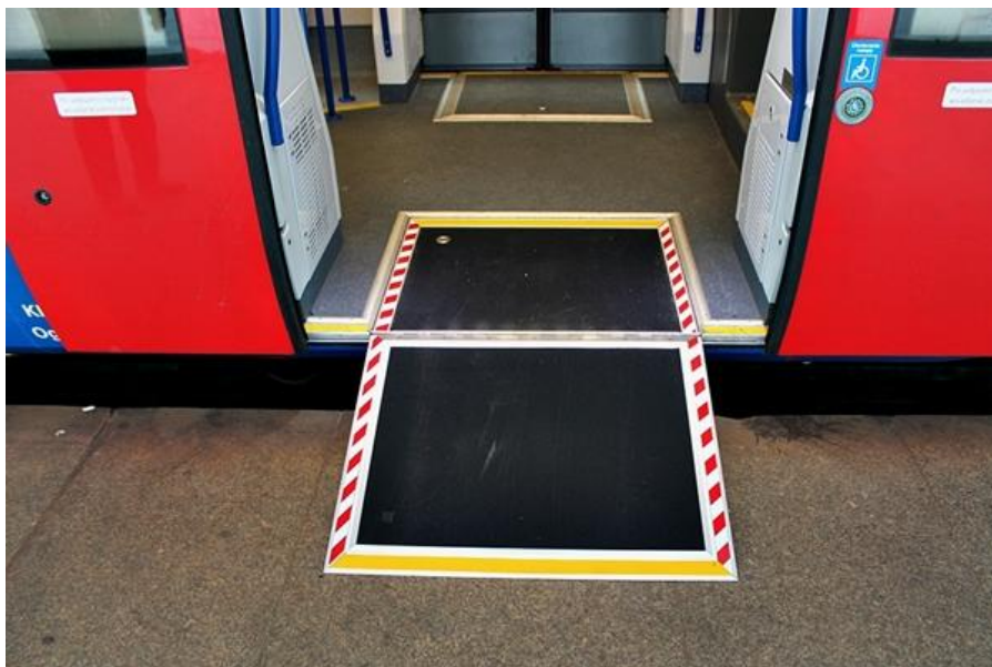
Zdjęcie 28 WKD Śródmieście. W nowych pociągach WKD zainstalowano rozkładane podjazdy, podobne do tych znajdujących się w autobusach.
