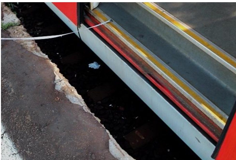
Zdjęcie 27 PKP Gocławek. Różnica poziomów pomiędzy peronem a podłogą SKMki oraz lokalizacja przystanku na łuku znacząco utrudniają wsiadanie pasażerów do pociągu.
