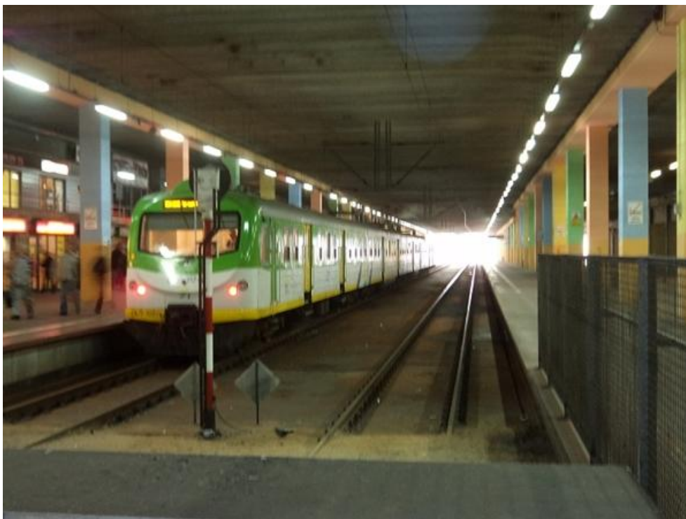
Zdjęcie 5 PKP Warszawa Wileńska mimo dostosowania peronów o wysokości 760 mm do potrzeb osób niepełnosprawnych jest obsługiwana w całości taborem o podłodze na wyższym poziomie
