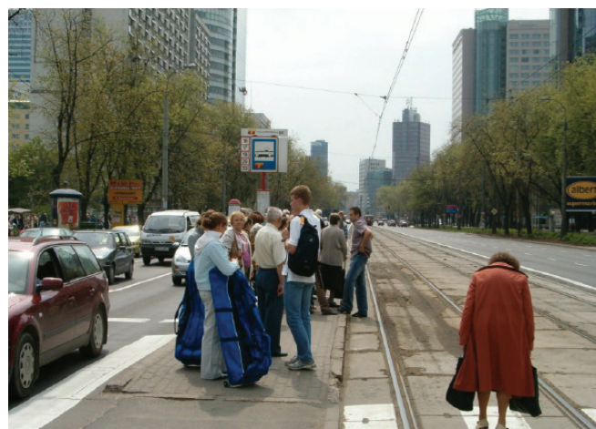
Fot. 19. Przystanek Hala Mirowska 04 . Wąska platforma przystankowa niewłaściwie chroni pasażerów przed ruchem pojazdów i „izoluje” od torowiska tramwajowego
