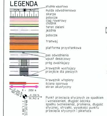
pobocze ciag rowerowy chodnik teren zieleni jezdnia pobocze tramwaj platforma przystankowa pas odwodnienia wpust deszczowy próg zwalniający krawężnik wystający przejście dla pieszych krawężnik wtopiony ściana oporowa
