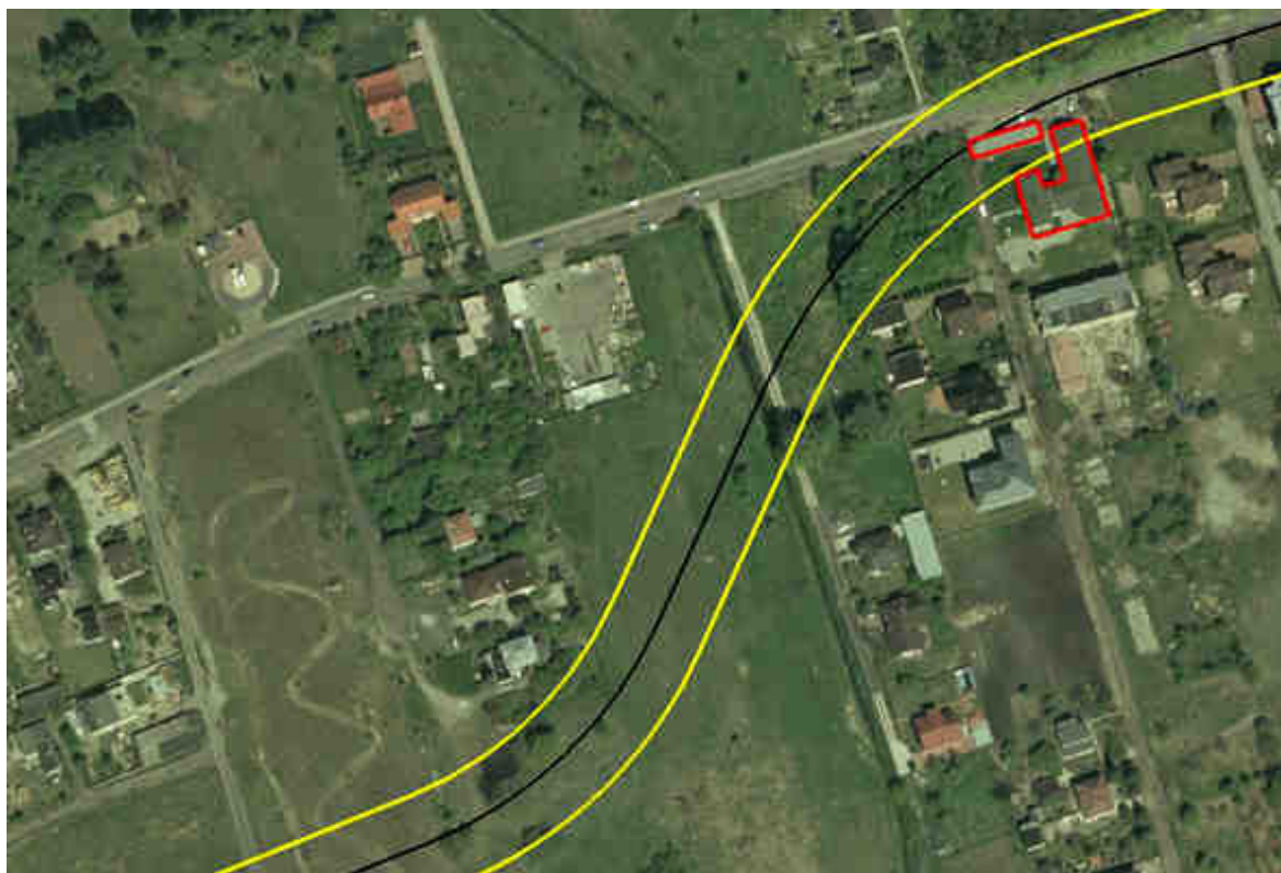
Rys. 5.12 Przebieg trasy przez obszar zabudowy jednorodzinnej w rejonie wejścia trasy w oś ul. Zwoleńskiej (na czerwono zaznaczono kolizje z istniejącą zabudową)
