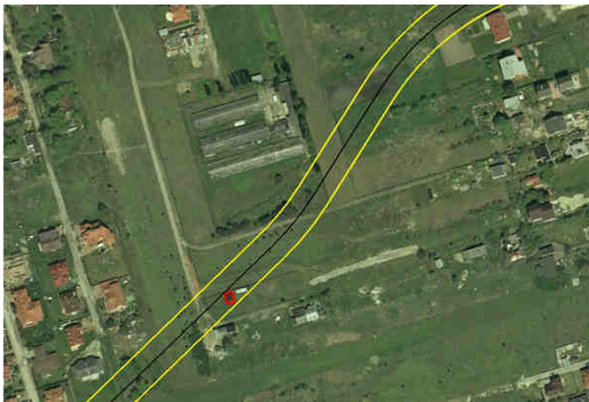
Rys. 5.17 Przebieg trasy przez obszar zabudowy jednorodzinnej na odcinku pomiędzy ul. Kwiatów Polskich z ul. Motylkową (na czerwono zaznaczone kolizje z istniejącą zabudową)
