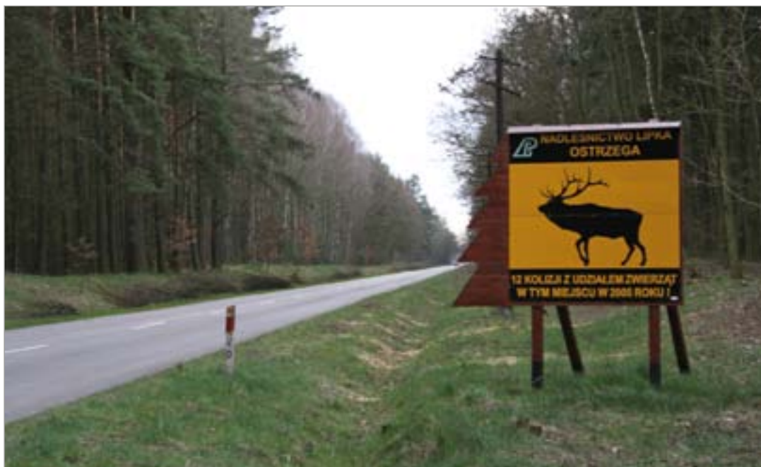
Fot. 25. Przejścia po powierzchni drogi wymagają wprowadzenie ograniczeń prędkości jazdy i zachęcania kierowców do ich przestrzegania – np. w postaci niestandardowych tablic ostrzegawczych.
