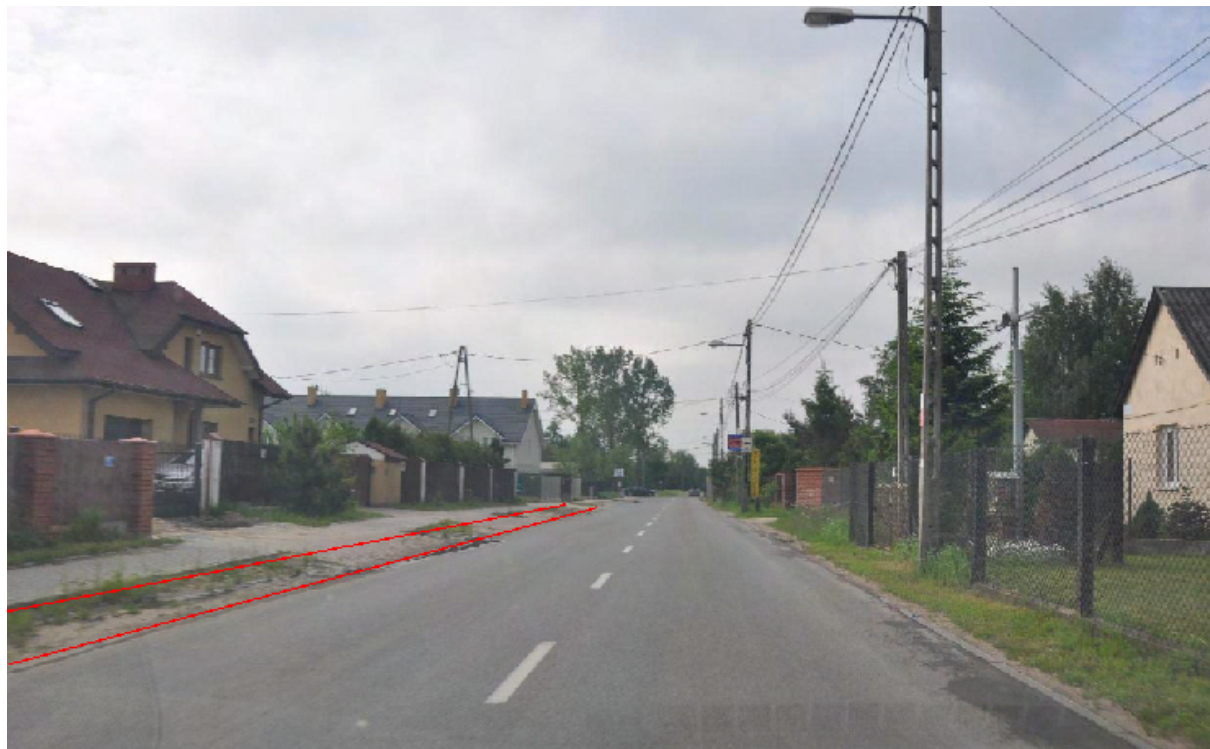
Rysunek 8.41 Proponowana lokalizacja dwukierunkowej ścieżki rowerowej o szerokości 2m po wschodniej stronie jezdni ulicy Ostródzkiej, okolice skrzyżowania z ul. Zdziarską.
